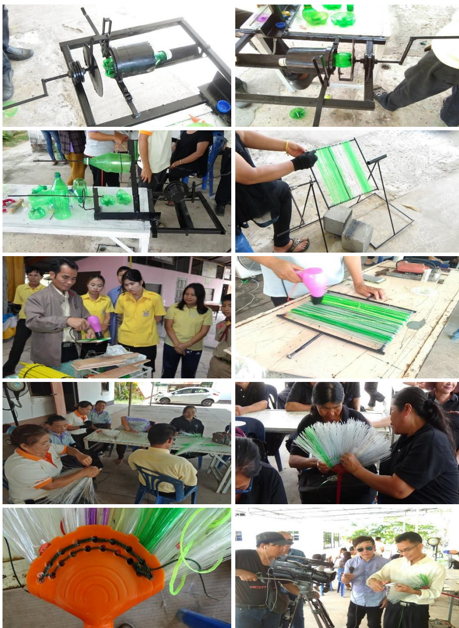
รูปที่ 5.1.4-1 ขั้นตอนการทำไม้กวาดโดยใช้นวัตกรรมสิ่งประดิษฐ์เครื่องรีดเส้นจากขวดพลาสติก
