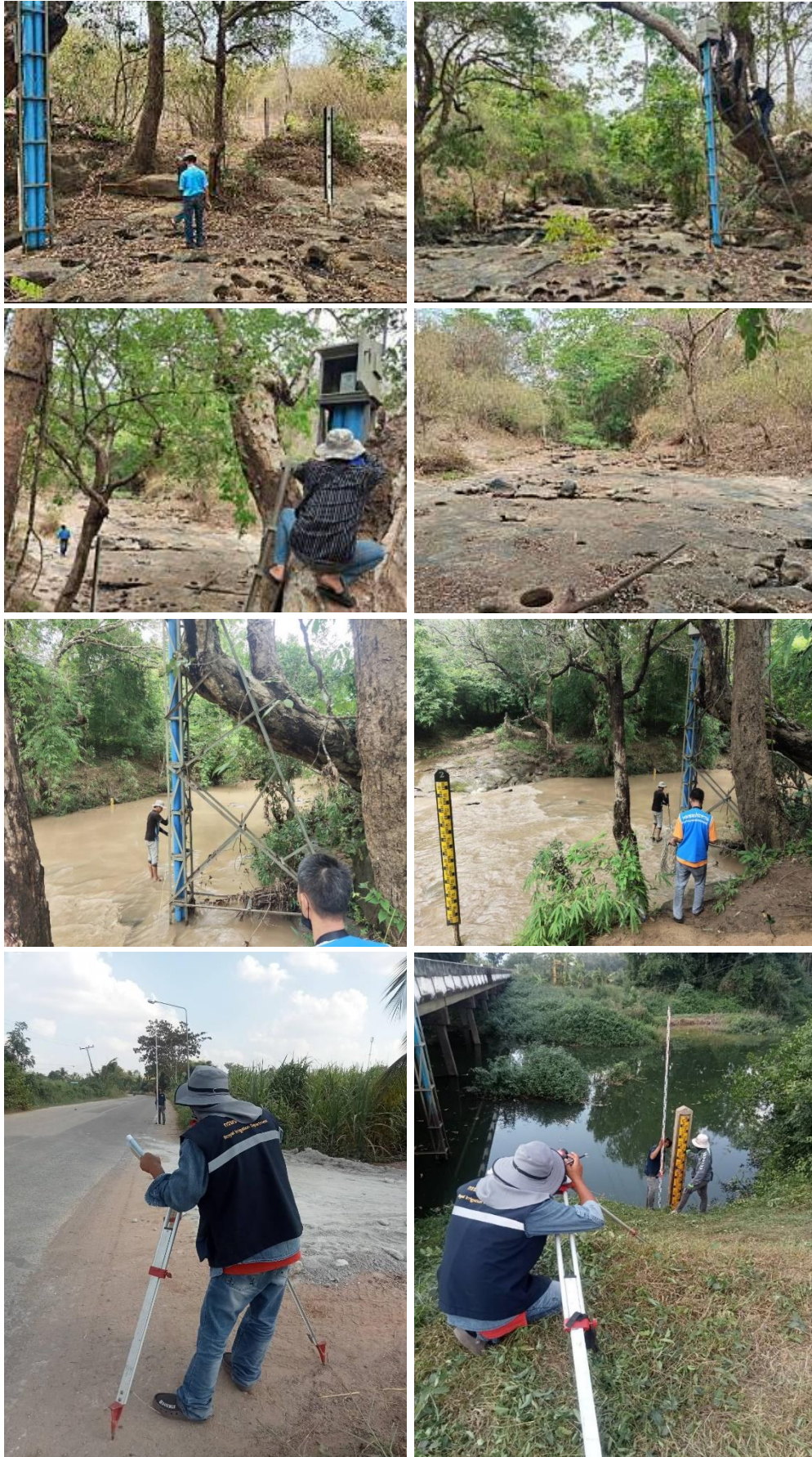
รูปที่ 5.2.2-16 การสำรวจรูปตัดขวางลำน้ำและสำรวจปริมาณน้ำ สถานี Kh.118 บ้านแก่งแต้ ตำบลบ้านค้อ อำเภอดำรงวิทยะ จังหวัดมุกดาหาร
