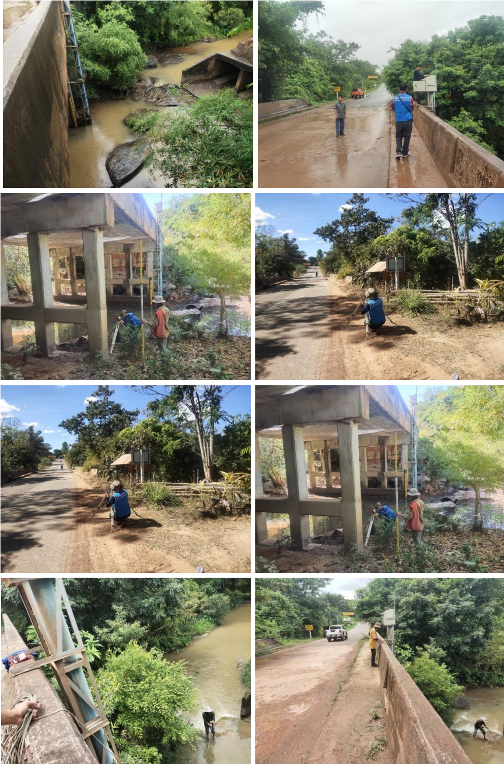
รูปที่ 5.2.2-17 การสำรวจรูปตัดขวางลำน้ำและสำรวจปริมาณน้ำ สถานี Kh.119 บ้านห้วยตาเปอะ ตำบลบ้านค้อ อำเภอคำชะอี จังหวัดมุกดาหาร
